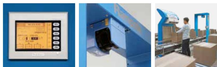
AccuFill besteht aus einem Inline-Messsystem, das die genaue Größe des Hohlraums in einem Versandkarton bestimmt. Das System gibt daraufhin ein Signal an den FillPak-Konverter, die optimale Papiermenge auszugeben, die notwendig ist, um den Hohlraum im jeweiligen Karton zu füllen, wobei bis zu 10 Kartons pro Minute bearbeitet werden. Die Produkte werden während des Versands geschützt und kommen unbeschädigt an ihrem Zielort an.
