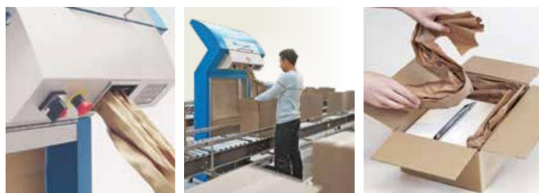
コンバーターは、1層のクラフト紙からハイボリュームの優れたすき間埋め材を製造します。箱の中で製品が移動するのを防ぎ、最終目的地まで破損のない状態で製品を届けることができます。作り出されたすき間埋め材は作業現場で直接投入でき、梱包作業の効率化、作業速度の改善を図ります。
