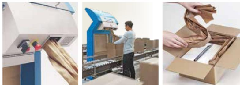
Der Konverter wandelt einlagiges Kraftpapier in sternförmiges Papier mit hohem Volumen um, das als sehr effektives Füllmaterial verwendet werden kann. Es verhindert, dass Produkte im Karton umherrutschen, und stellt so die unbeschädigte Ankunft am Zielort sicher. Das umgewandelte Papier wird direkt am Arbeitsort zur Verfügung gestellt, was die Effizienz des Verpackungsvorgangs verbessert und das Arbeitstempo optimiert.
